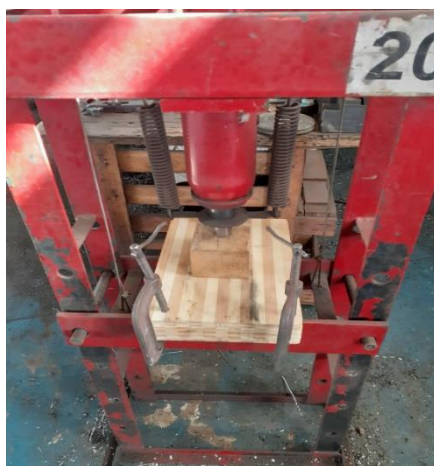
Figura 3 - Processo de colagem do bloco de bambu.
